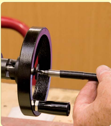
22 : Remove X-Axis handwheel...
