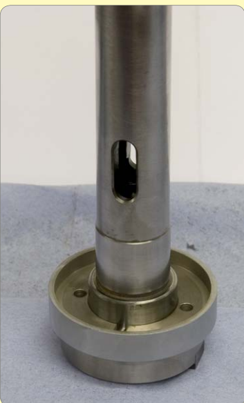
79: Press flange onto spindle
